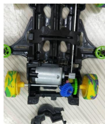
車底有馬達扣及齒輪箱扣 掰開取出蓋子
