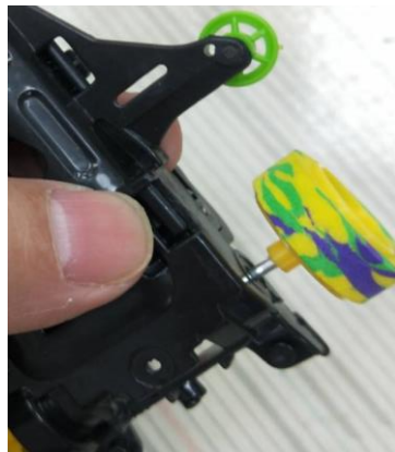
車底有馬達扣及齒輪箱扣 掰開取出蓋子
