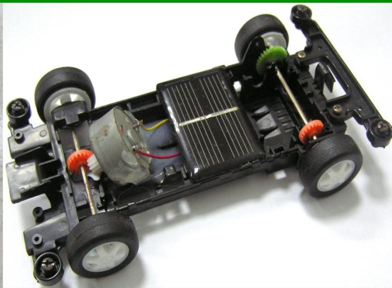
同樣以光能轉換電能的理論，以教師箱內附上的齒輪，DIY改裝玩具車將其應用在生活上，亦可利用資源回收材料自行製作太陽能車。
